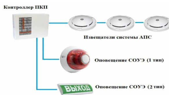
Рисунок 1. Принцип работы системы оповещения
